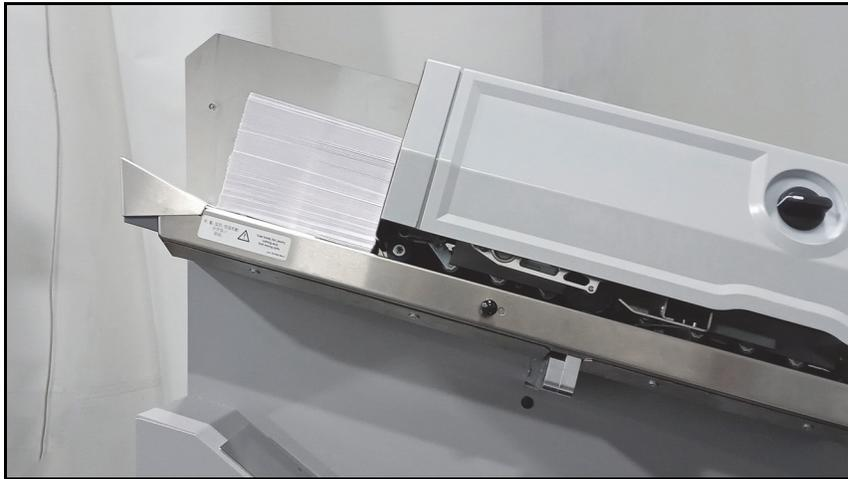
**Figure 5-6 : Courrier positionné dans le chargeur**
